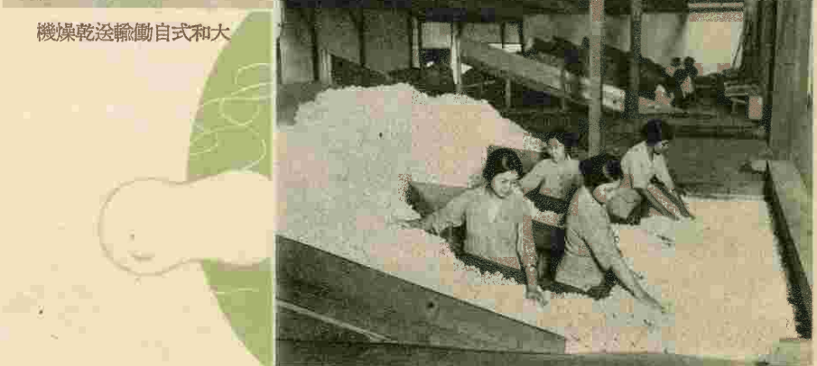
大和式自動輸送乾燥機の繭給への作業
