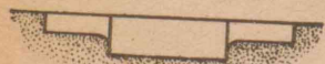
(2) 面取り, 木型に面がついて るない時は忘れずに面をとる
