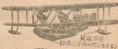
第21圖の1 離着水装置 (双浮舟水上機)
