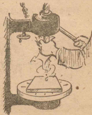
第 12 圖 (7) 運轉中のボール盤錐軸掃除は禁物
