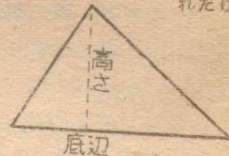
第8圖 三角形の面積 = \frac{1}{2} \times (\text{底邊}) \times (\text{高さ})
